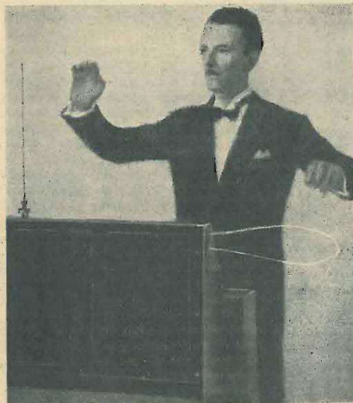
Fig. 7. — Strumento in cui i mutamenti elettrici dei circuiti oscillanti sono prodotti dal movimento delle mani nell'aria.
